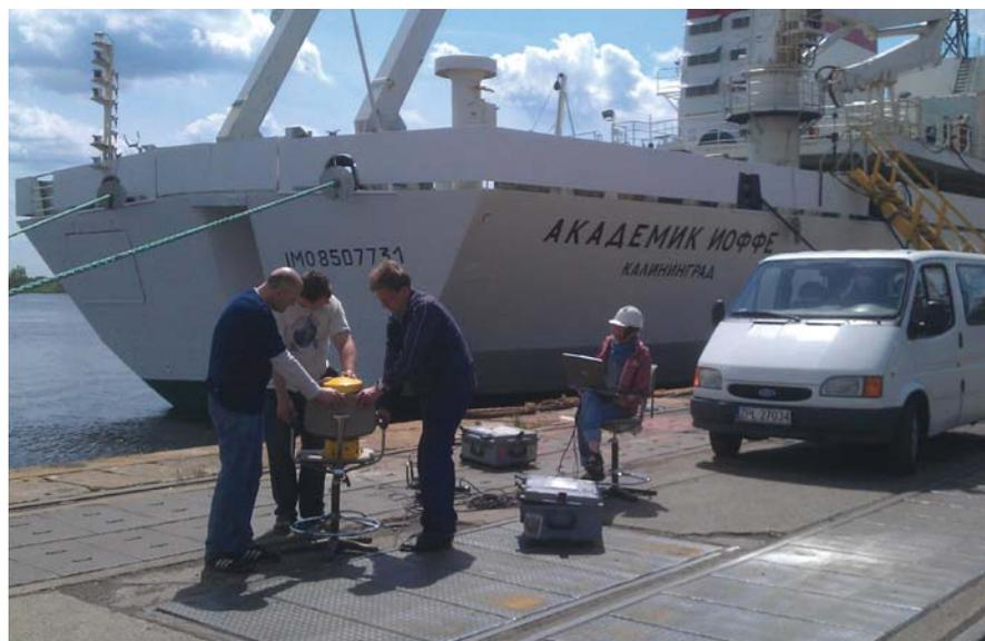
*Калибровка погружаемого доплеровского измерителя скорости течения (LADCP) перед рейсом*
