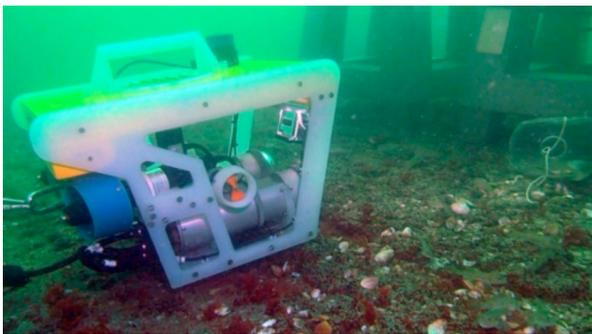
Рис. 7 ТНПА СуперГНОМ-ПРО на дне в процессе выполнения измерений прозрачности окружающей водной среды.
