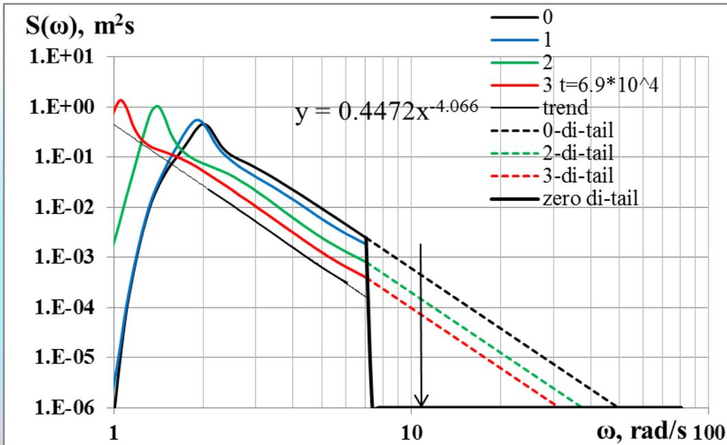
Рис.10. Пояснение к расчетной форме хвоста. Стрелка-предельная частота в 4-в конфигураци. Сплошная жирная-полное отрезание хвоста при учете диссипации за пределами расч. области (Бадулин др. 2005)
