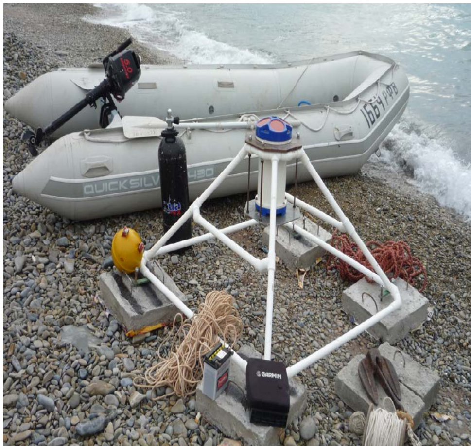
Заякоренный донный профилограф ADCP RDI WH 600 кгЦ
