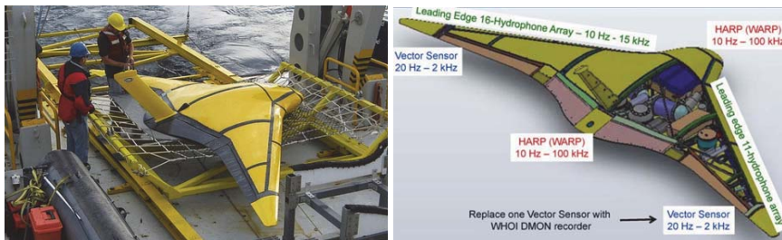
Рисунок 1 – Глайдер Z-Ray: слева – фото, справа – размещение гидроакустической аппаратуры
