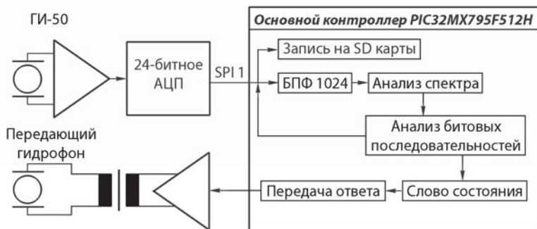
Рис. 1. Совмещенная структурная схема модема и блок-схема алгоритма его работы.
