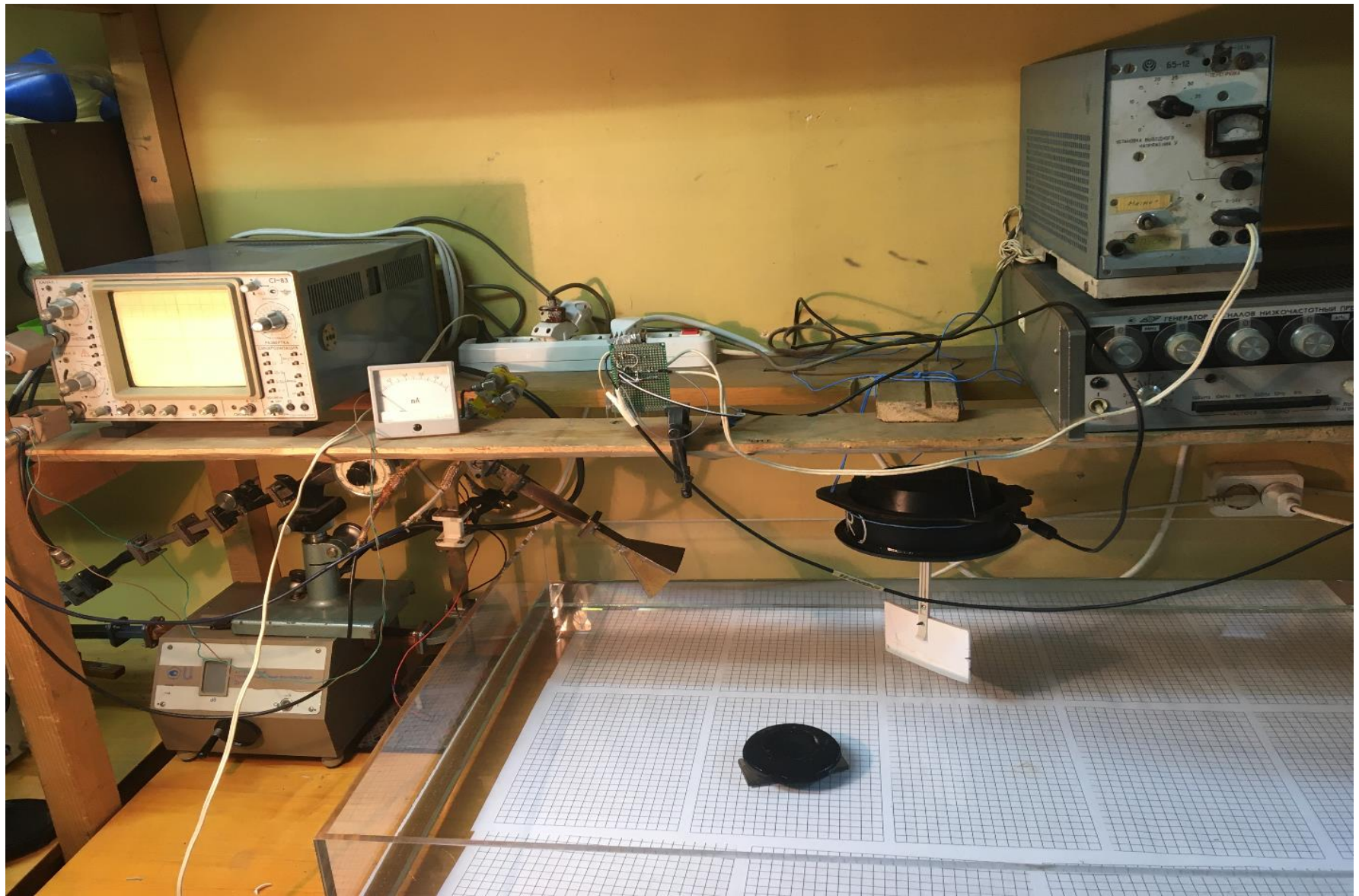
Лабораторная установка. Видны ванна, рупорная антенна локатора, лопатка приповерхностного вибратора и донный вибратор
