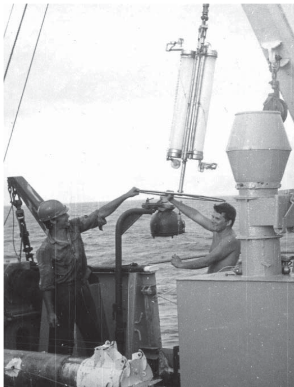
Сдвоенные батометры для отбора пробы в придонном нефелоидном слое. 28-й рейс НИС «Дмитрий Менделеев», Тихий океан, 1982 г.
