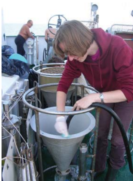
Подготовка седиментационных ловушек к постановке в Белом море. На переднем плане М.Д. Кравчишина
